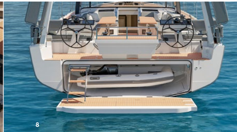
1 Zwei klappbare Steuermannssitze 2 Sonnenpolster-Paket 3 Cockpittisch mit Teakplatte, elektrisch zu Liegefläche absenkbar 4 Gashebel am Instrumententräger 5 Zwei GFK-Steuerräder, Y-Speichen (schwarz oder weiß) 6 Zweites Vorstag mit Rollanlage 7 Zwei elektrische LEWMAR 65 EST EVO Schotwinschen 8 Automatisch ausklappbare Badeplattform mit Badetreppe und Fernbedienung 9 Zwei zusätzliche elektrisch betriebene Schiebeluken beiderseits des Niedergangs 10 Wetbar mit Grill, Spüle und Kühlschrank
